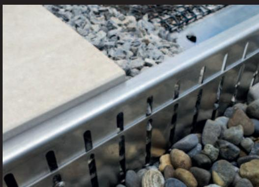
Das **variafix®** erlaubt die Befestigung des Belags inklusive dem Splittbett. Das Element ist in der Höhe verstellbar und kann so auch im Gefälle eingesetzt werden. Dank dem montierten Geogitter wird das **variafix®** durch das Eigengewicht des Belags dauerhaft und ohne Nägel fixiert. **variafix®** besteht aus einem Basiswinkel und einem angeschraubten und höhenverstellbaren Aufsetzelement. Das Element ist in zwei Höhen verfügbar.
