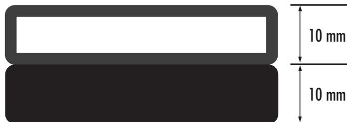
Die versetzte Anbringung der EPDM-Distanzen ermöglicht den Einbau der Schienen sowohl längs als auch quer zur Wasserfließrichtung.
